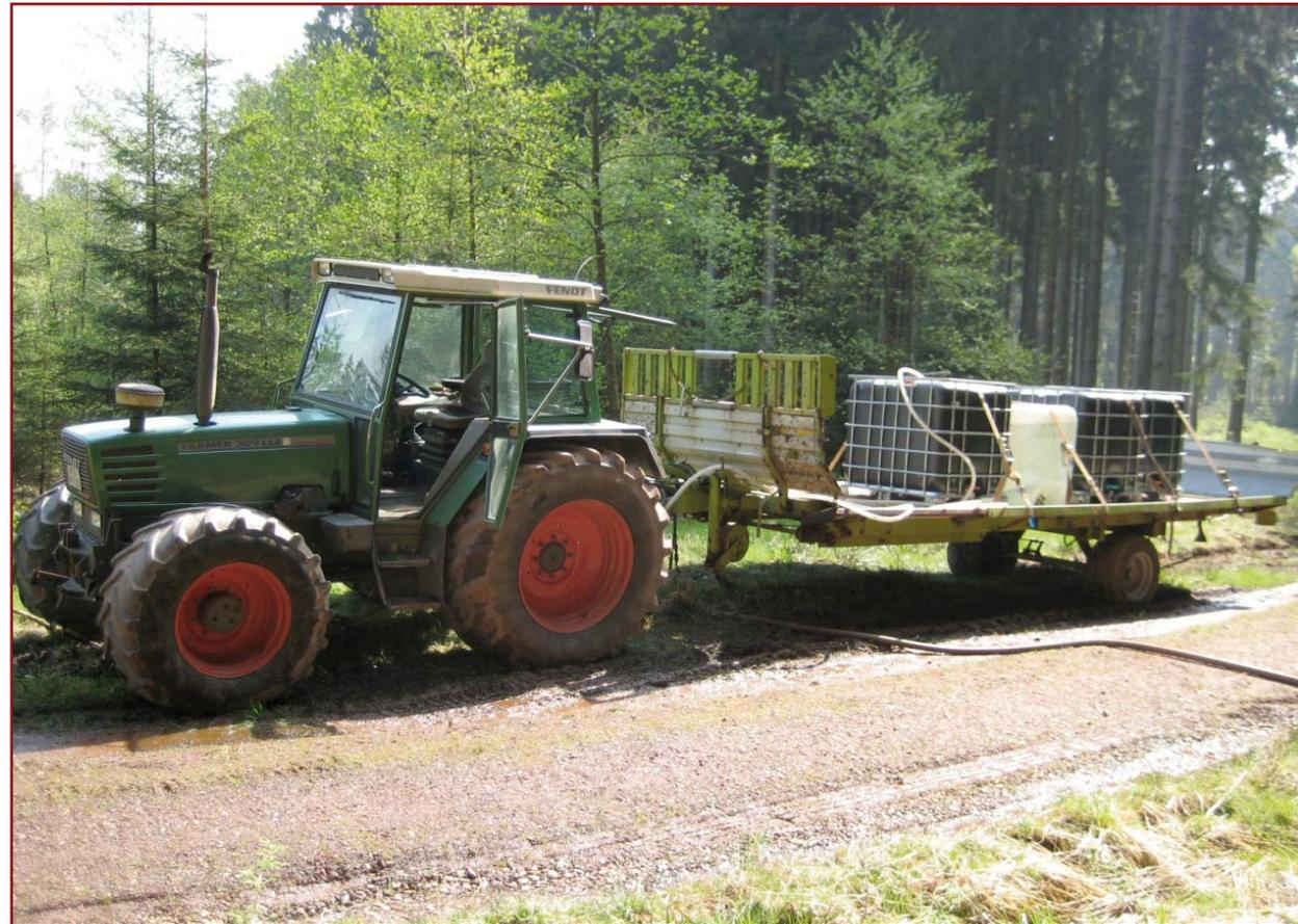
Abb.17: Traktor mit 4x 1000l Fässern zur Beregnungssimulation (M. Hümann)
